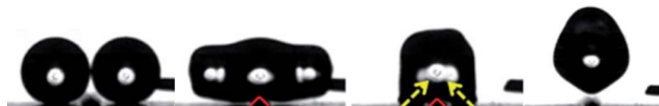
柱状微结构促进合并液滴的自弹跳
