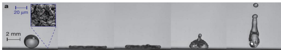
微结构改变表面浸润性实现反弹
